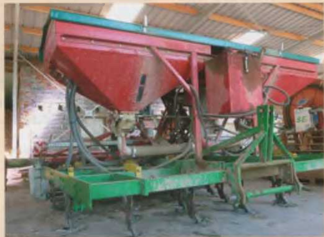
Outil "maison" polyvalent fabriqué par Michel Roesch. Cet outil est utilisé pour déchaumer, scalper, semer et fertiliser.
